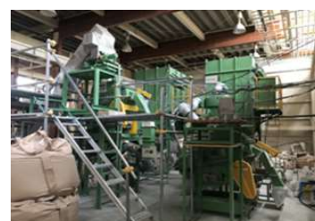
鹿児島県工業技術センターと開発した多段気流分級装置
