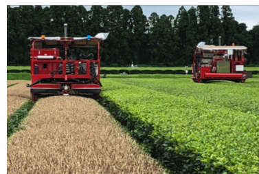
ロボット機による中切&摘採作業
