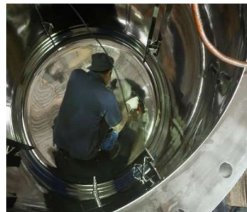
貯蔵タンク内面電解研磨処理品
