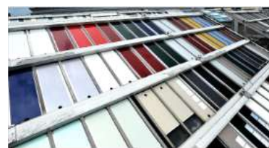
屋外曝露試験
